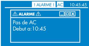
Dès que le défaut disparaît, retour de l'écran général sur lequel apparaît une notification d'alarme. Pour supprimer la notification d'alarme, il suffit d'appuyer sur l'un des deux boutons marche forcée. Le détail des alarmes peut être consulté dans le journal des alarmes.
